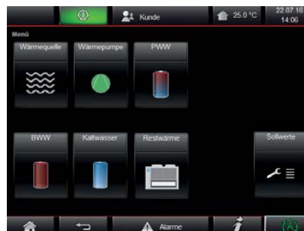
Einfach zu bedienende SPS-Regelung mit Farb-Touch-Display
