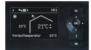
Einfach zu bedienende Vitotronic Regelung mit Klartext- und Grafikanzeige
