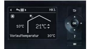
Display der Wärmepumpenregelung Vitotronic 200
