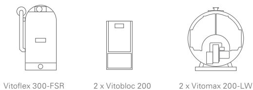
Nahwärmenetz mit einer Heizlast von 7,5 MW Multivalente Heizungsanlage
