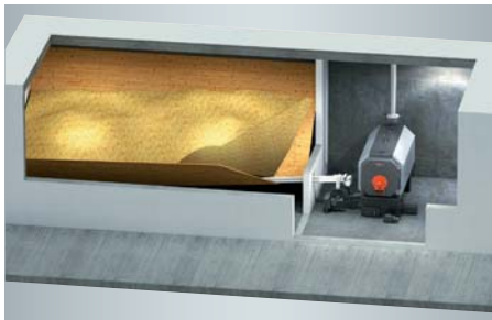
Kellerlagerung mit Pelletschnecke
