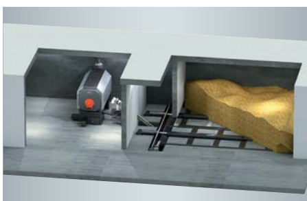
Bunker mit Schubboden
