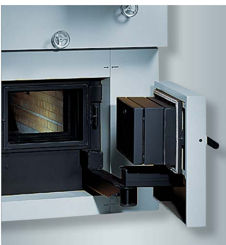
Mit Schamottesteinen gemauerter Feuerraum mit Außenrost und bewegtem Vorschubrost
