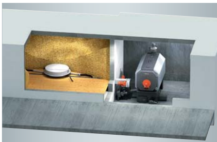
Bunker mit Rührwerksaustragung (Federkern- oder Horizontalaustragung)
