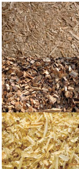
Verbrennung von Holzhackschnitzeln, Restholz aus der Holzverarbeitung, Spanplatten, MDF, Späne
