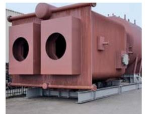
Kombinierter Wasserrohr- und Großwasserraumkessel
