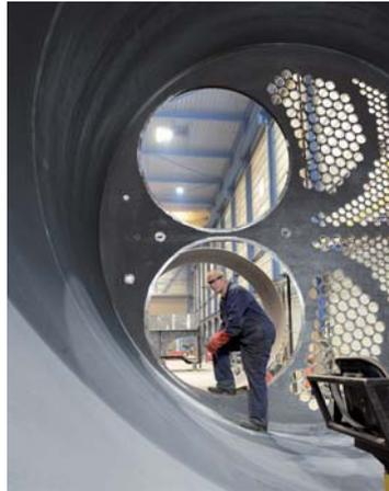
Qualitätsprüfung eines Doppelflammrohrkessels
