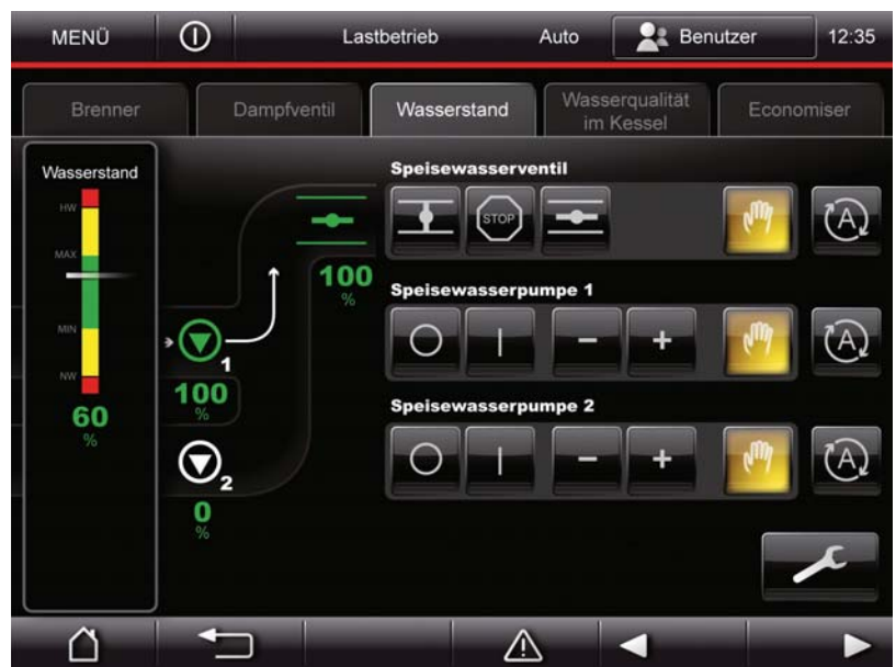
Darstellung der Einstellebene Speisewasserregelventil
