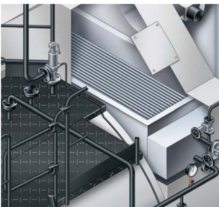
Einblick in den integrierten Economiser eines Dampfkessels
