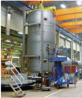
Verschweißen des Druckkörpers in optimaler Schweißposition
