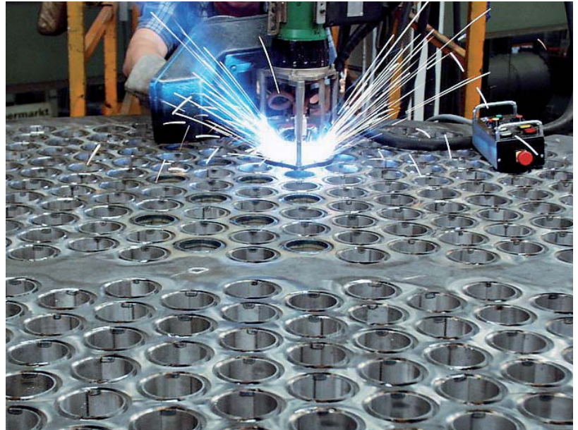
Siederohreinschweißung mit mechanischen Einschweißgeräten
