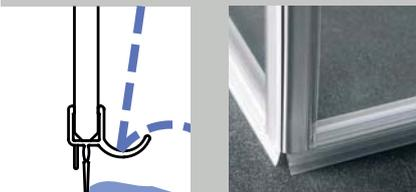
Fehlt unten eine „Profil-Barriere“ oder Schwelle, findet das Spritzwasser leichter einen Weg ins Freie. Für einen zufriedenstellenden Spritzwasserschutz bei bodenfreien Duschkabinen sorgt eine spezielle waagerechte Dichtleiste mit Wasserabpralleffekt.
