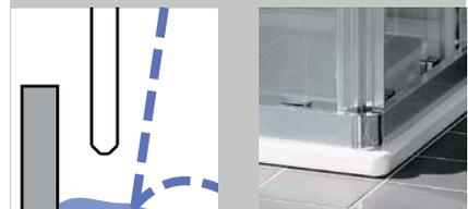
Das untere Bodenprofil wirkt wie ein Damm gegen den auf den unteren Wannenrand auftreffenden Brausestrahl bzw. aufgestauten Spritzwasser. Je höher es ist, desto höher ist der Spritzwasserschutz.
