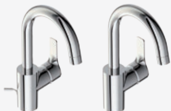
Einhebel-Waschtischarmatur mit hohem Auslauf, mit Zugstangen- Ablaufgarnitur 1 1/4", 120 Grad schwenk- barem Rohrauslauf, Ausladung 146 mm, Montage mit flexiblen Schläuchen
