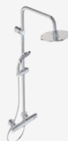
Brausethermostat Aufputz 3-Funktionenhandbrause M3, Kopfbrause Ø 200 mm, wasserführende Brauestange, Handbrause Ø 100 mm, Brauseschlauch 1750 mm
