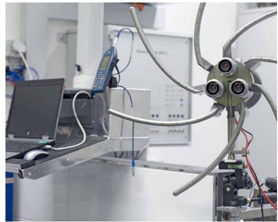
↑ Mit dieser akustischen Kamera der neuesten Generation können versteckte Geräuschquellen – beispielsweise in einer Abwasserleitung – exakt lokalisiert werden.
