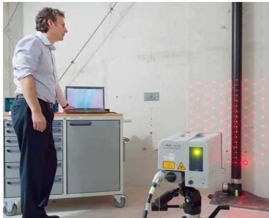
↑ Oliver Wolff, Leiter der Bauphysik bei Geberit, misst mit dem Laserscanner die Vibrationen einer Falleitung.
