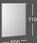
LICHTSPIEGELELEMENT* B 600 / H 710 / T 55 mit Sensorschalter (dimmbar) und Anti-Beschlag (36 W) Direkte Beleuchtung: 22,5 W, 1495 lm Indirekte Beleuchtung: 25 W, 4200 K, 1540 lm Lichtspiegelement 807860000
