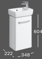
HANDWASCHBECKEN-UNTERSCHRANK B 348 / H 604 / T 222 1 Tür, Türanschlag rechts / links, 1 fester Einlegeboden, 1 Griff, kombinierbar mit Möbelfüßen Korpus: weiß Matt-Lackierung, Front: weiß Hochglanz-Lackierung Korpus: hellgrau Matt-Lackierung, Front: hellgrau Hochglanz-Lackierung
